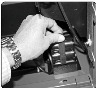
3. Aprete la cinta con el velcro para que el portapilas y las pilas queden bien sujetas al soporte.
