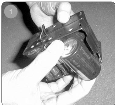
1. Coloque las pilas respetando la polaridad del portapilas.
